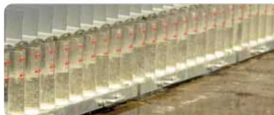
50 cm nad powierzchnią opryskiwaną - ciecz robocza rozkłada się jednolicie.
