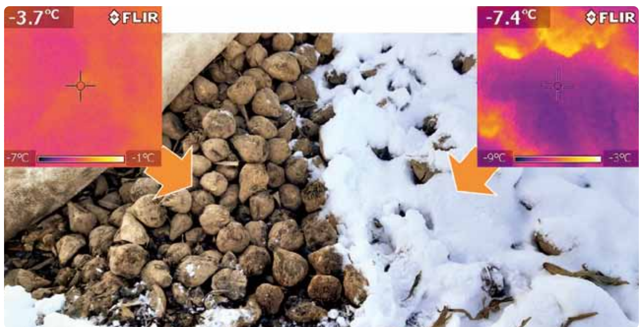
Fot. 17. Kamera termowizyjna pozwala na miejscu porównać temperaturę na powierzchni buraków w chwili po odkryciu i buraków nieokrytych pod śniegiem.
